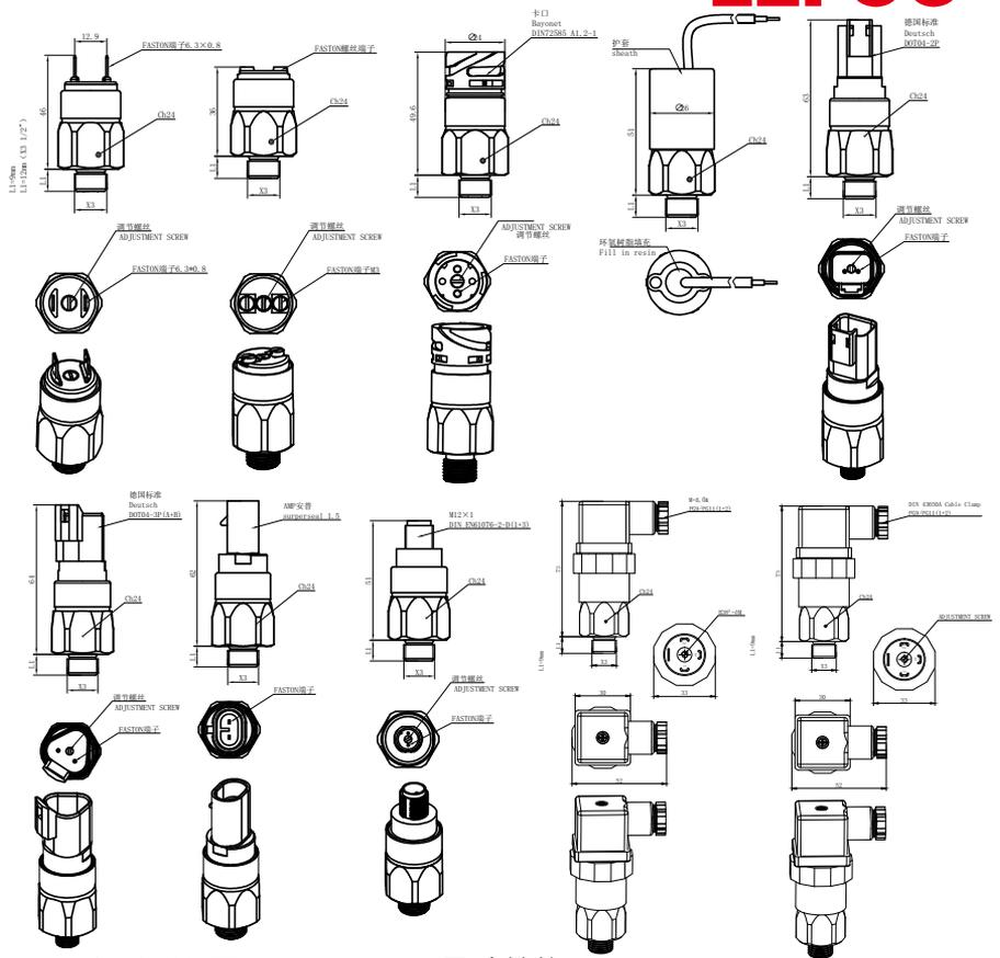
在工业和汽车领域，通常会为设备设定某压力值，当达到该压力值时系统将发出电子信号，使机械设备开始工作或者发出提示（如设备发生泄露、发出警报等）。这种操作可以通过一种名为压力开关的压力传感器进行控制。此为柱塞式压力开关，安全过压不超过600bar，接头螺纹可定制
